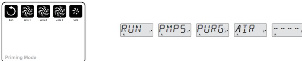
Betätigen Sie in dieser Zeit keine Tasten. Danach wird der Heizstab aktiviert, der Außenwhirlpool wird im Standardmodus gestartet und heizt das Wasser bis zur eingestellten Temperatur auf. Sie können den Inbetriebnahme-Modus manuell beenden, indem Sie die „Temp“-Taste drücken (nach oben/unten).
